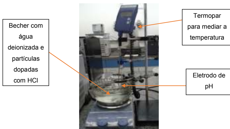
Figura 22: Aparelhagem utilizada para verificar a liberação de ácido clorídrico das partículas.
