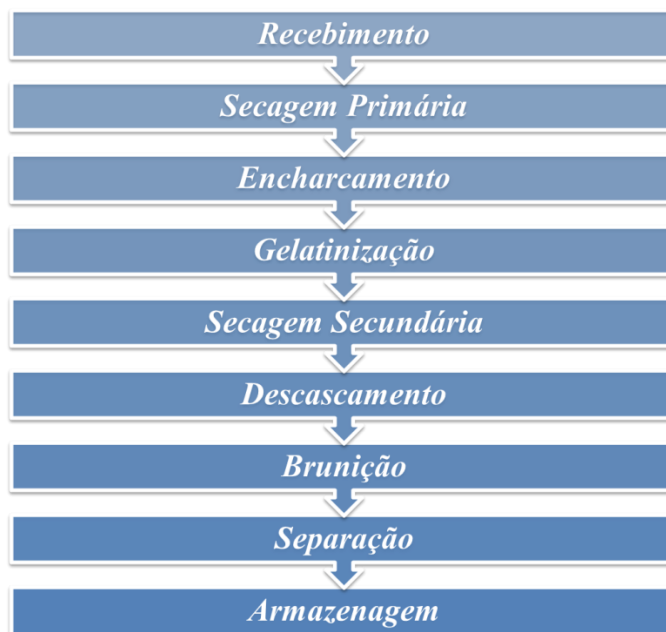
Fig. 3 – Diagrama de blocos simplificado do processo de beneficiamento do arroz parboilizado
