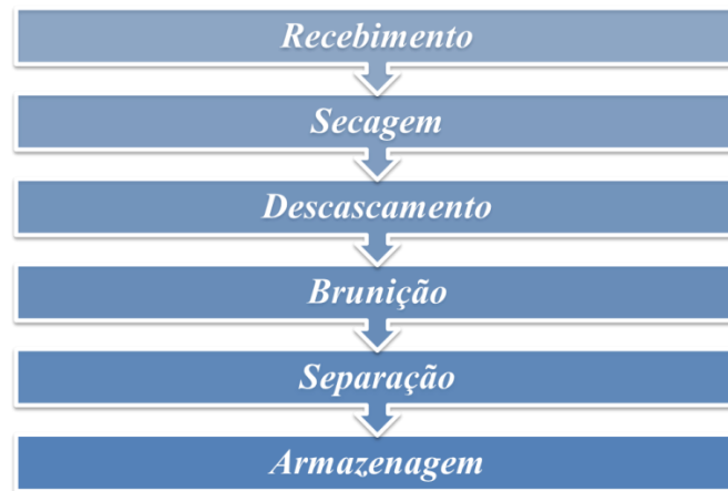
Fig. 2 – Diagrama de blocos simplificado do processo de beneficiamento do arroz polido
