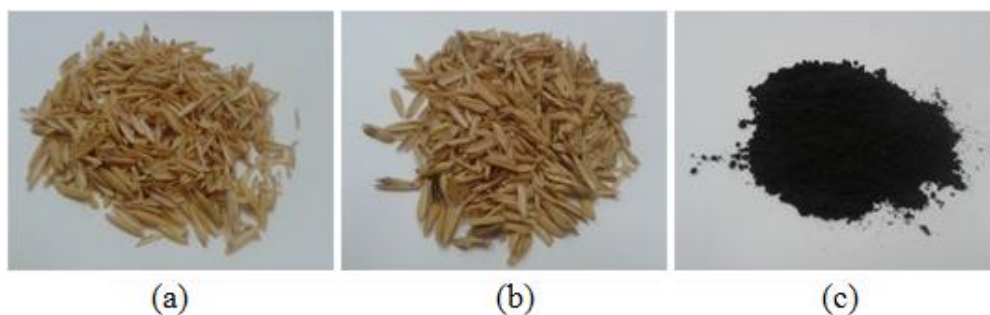
Fig. 10 – Fotografia das cascas de arroz polido (a), casca de arroz parboilizado (b) e carvão (c)
