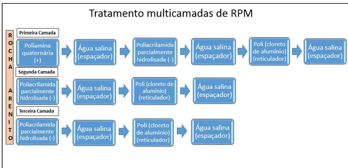
FIGURA 12: Mecanismo de adsorção em multicamadas como a técnica RPM em arenito.
