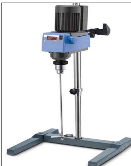
FIGURA 23: Agitador IKA modelo Eurostar ( www.ika.com ).
