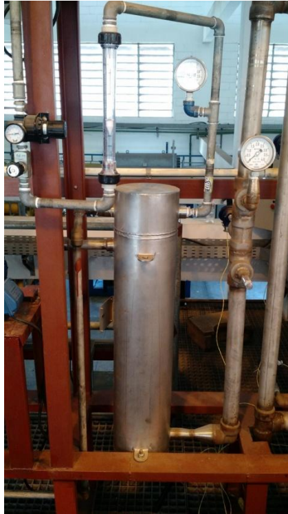
Figura 4.5. PPF-FGD-1: recuperador de calor (economizador) de gás exausto para pré-aquecer ar frio de carga com exausto quente do ciclone do FBR. Inclusos rotômetro de ar frio de carga, sensores de temperatura e pressão.
