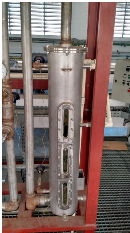
Figura 4.6. PPF-FGD-1: vaso de lavagem com recheio Pall-Ring 5/8" para gás exausto vindo do recuperador de calor para reter sólidos volantes e ajustar a temperatura do gás final para a atmosfera.
