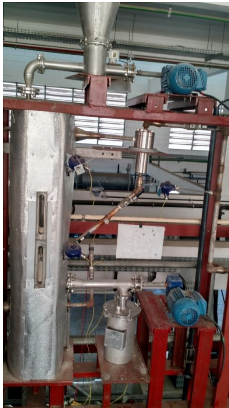
Figura 4.4. PPF-FGD-1: reator FBR com jaqueta de ar estagnado para isolamento térmico. Incluso ciclone de saída no alto à direita, silo de topo com rosca de carga de R-FGD e rosca de retirada de R-FGD no fundo.
