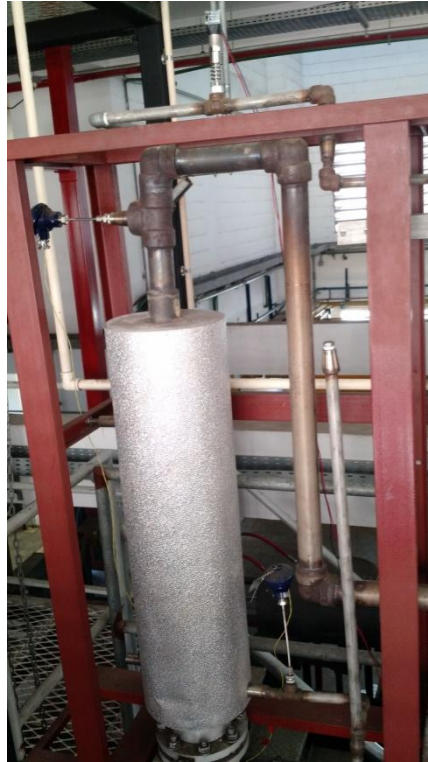
Figura 4.3. PPF-FGD-1: aquecedor de ar com isolamento de fábrica, saída de ar quente no topo.
