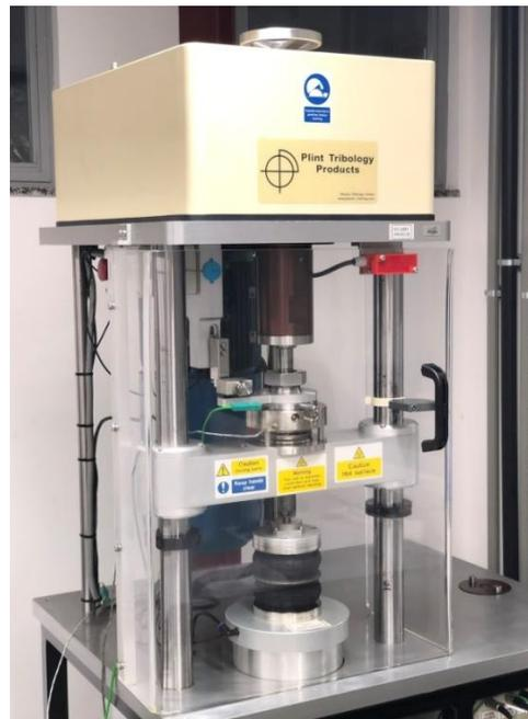
Figura 25 – Equipamento para ensaio em 4 esferas do laboratório de tribologia da COPPE
