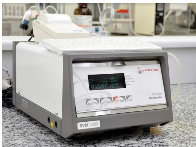
Figura 23 – Viscosímetro stabinger da Anton Paar do DOPOLAB
