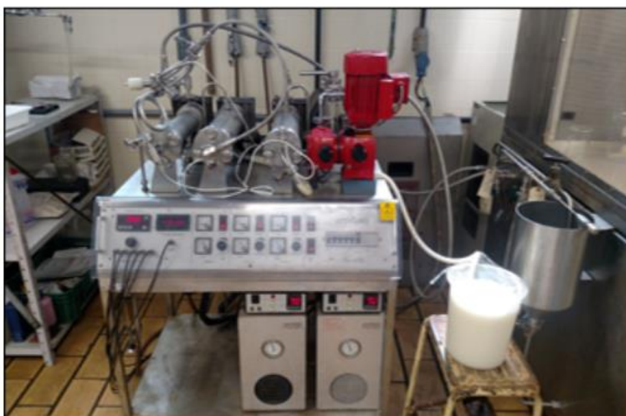
Figura 12: Pasteurizador de superfície raspada (FT25D, Armfield, Inglaterra).
