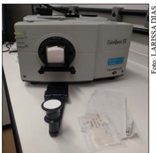
Figura 17: Colorímetro Color Quest XE, Hunterlab.
