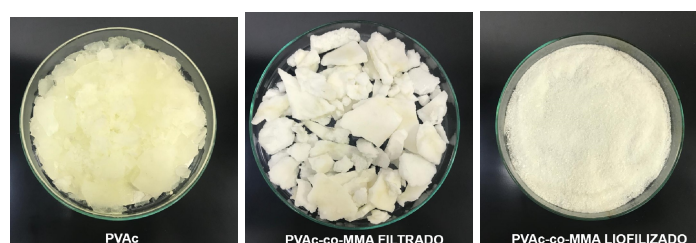
Figura 4.12: Amostra de PVAc filtrada e seca, P(VAc-co-MMA) filtrada e seca e de P(VAc-co-MMA) liofilizada.
