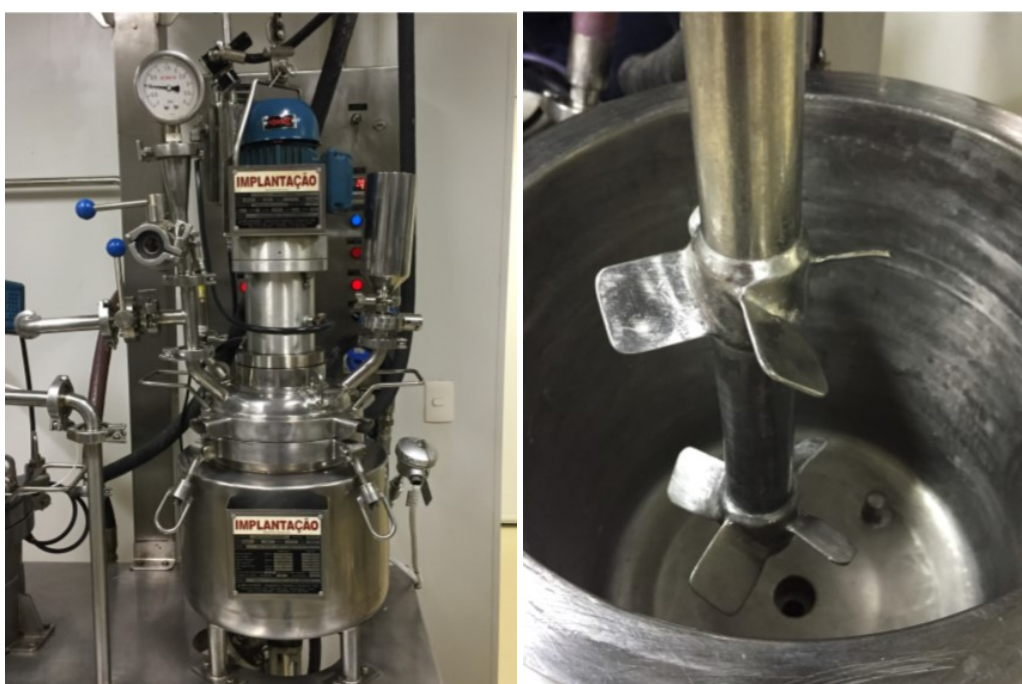
Figura 3.2: Reator utilizado para conduzir as reações em escala piloto e esquema das pás do agitador.
