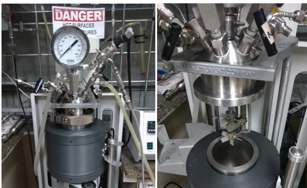
Figura 3.1: Reator utilizado para conduzir as reações em escala bancada e esquema de pás do agitador.
