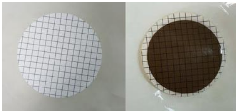
Figura 18 - Membrana Antes (Esquerda) e Após (Direita) o Processo de Permeação para Análise de MFI.
