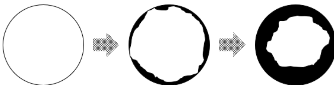
Figura 5 - Processo de Incrustação de uma Tubulação. Fonte: Elaboração Própria.
