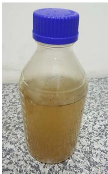
Figura 17 - Emulsão Sintética Utilizada para Representar a Água Produzida de Concentração de Óleos e Graxas de 100 mg.L -1 .
