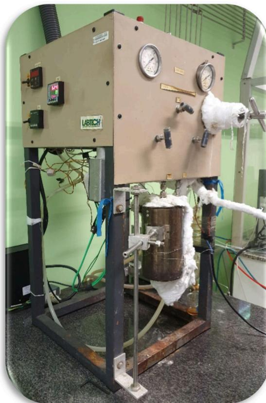
**Figura 3.5:** Imagem da unidade reacional utilizada nos ensaios catalíticos.
