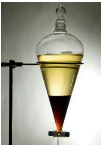
**Figura 2.8:** Separação de fases biodiesel/glicerol.
