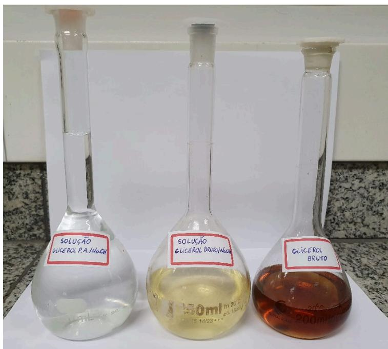
**Figura 3.1:** Solução de glicerol P.A., solução de glicerol bruto e glicerol bruto sem pré-tratamento.
