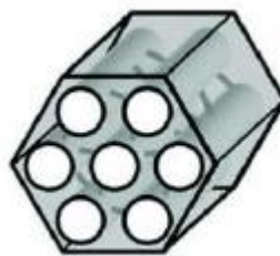
Figura 6: Representação estrutural da SBA-15. Fonte: ROBERTS et al, 2014
