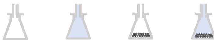
Figura 23. Ilustração do sistema considerado na metodologia, indicando, da esquerda para a direita, o picnômetro vazio, preenchido somente com água, preenchido somente com a amostra sólida e preenchido com a amostra sólida e água. Todos os sistemas foram considerados sob temperatura igual a 23°C.
