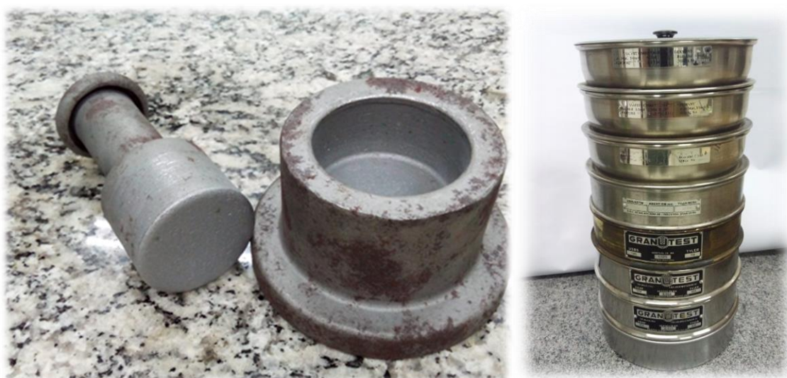
Figura 24. À esquerda, grau e pistilo metálicos em condição anterior ao jateamento de areia, indicando pontos de corrosão que foram eliminados anteriormente ao início do processo de cominuição da amostra. À direita, coluna de peneiramento ordenada da abertura de malha igual a 600 \mu\text{m} até 37 \mu\text{m} , incluindo o fundo para receber o passante da peneira de menor abertura.
