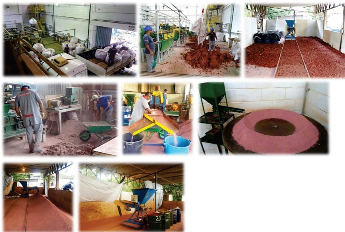
Figura 20. Tratamento prévio realizado no SENAI | FIEMG, contemplando os estágios de recebimento do resíduo, secagem, cominuição, classificação, homogeneização e quarteamento.
