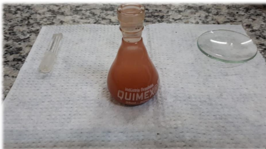
Figura 22. Picnômetro de 25 mL (centro) provido de um dispositivo dotado de rolha de vidro esmerilhado e de um capilar (à esquerda). Observa-se o picnômetro preenchido com água e a amostra do resíduo, cuja densidade almeja-se determinar. O registro foi realizado durante a decantação/sedimentação da amostra, necessária para evitar o risco de perda de material durante o acoplamento do capilar, bem como o seu eventual entupimento.
