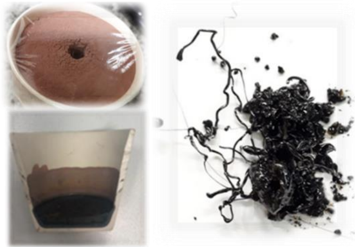
Figura 32. Exibição do cadinho ZAS preenchido com a amostra de resíduo, a qual é dotada de um orifício, cuja finalidade é evitar (ou mitigar) a aspersão do material por liberação de gases. Exibe-se também o corte transversal do cadinho após o processamento térmico, indicando baixo impacto corrosivo sobre a superfície do acondicionador, justificando o seu uso. Por fim, a frita (fragmentos de vidro) resultante do quenching é exibida.
