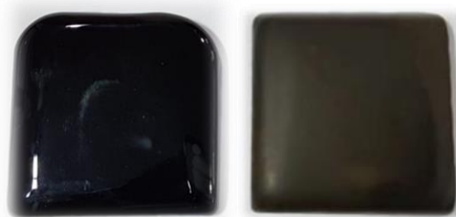
Figura 37. À esquerda, prova de conceito de peça de vidro. À direita, prova de conceito de peça vitro-cerâmica.
