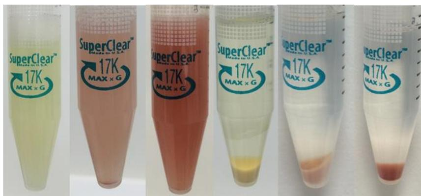
Figura 29 - Coloração da nanosilicalita funcionalizada em função da concentração de glutaraldeído.
