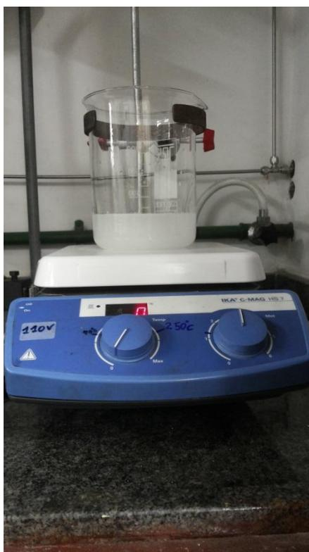
**Figura 24:** Sistema de agitação magnética da solução contendo o sal do metal e o PVA.
