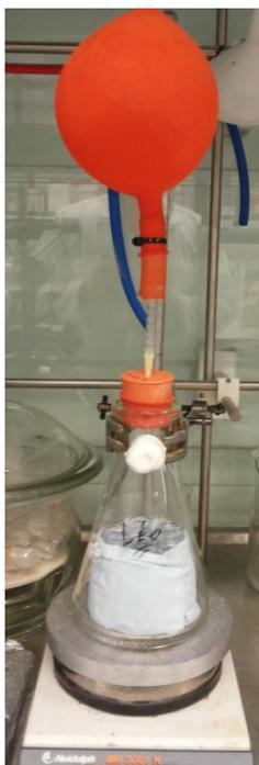
**Figura 30:** Sistema reacional empregado nas reações de conversão de epóxido a 1 bar e temperatura ambiente.
