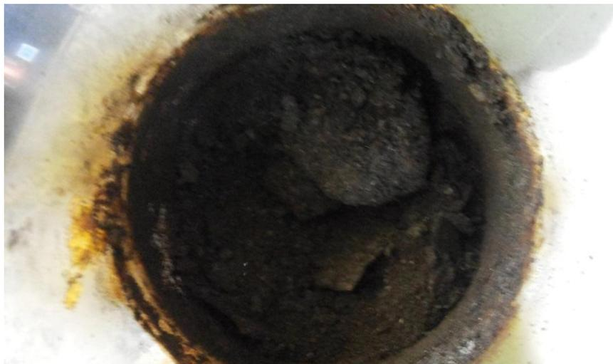
**Figura 25:** Material obtido após combustão do material orgânico, sólido precursor dos óxidos metálicos.
