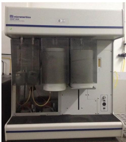
**Figura 27:** ASAP 2020 Micromeritics utilizado para análise textural dos óxidos metálicos sintetizados.
