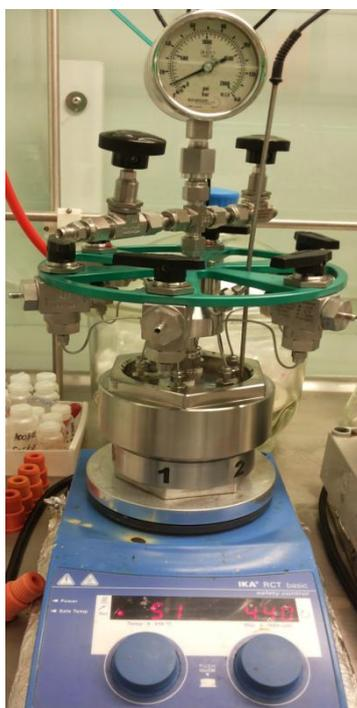
**Figura 31:** Sistema reacional empregado nas reações de conversão de epóxido a pressões superiores a 1 bar.
