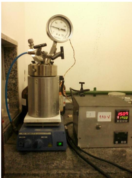
**Figura 29:** Sistema do reator montado e em uso.
