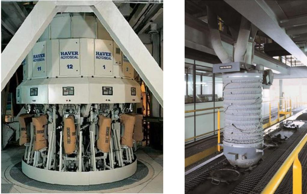
**Figura 35. Imagem de ensacadeira pneumática (esq.) e sistema de carregamento a granel (dir.).
