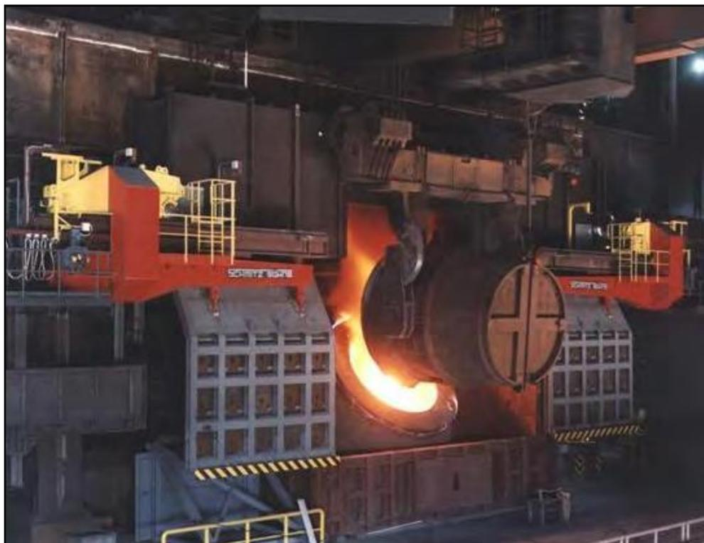
**Figura 60. Carregamento de ferro gusa no conversor LD, com auxílio de pontes rolantes.**
