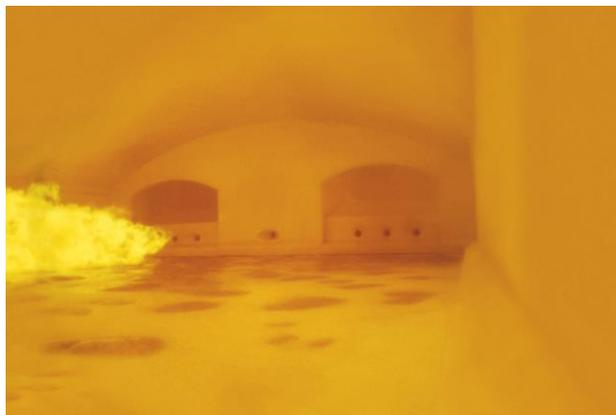
**Figura 14. Imagem do interior de um forno de fusão de vidro em operação (Fonte: The Linde Group, 2017).**
