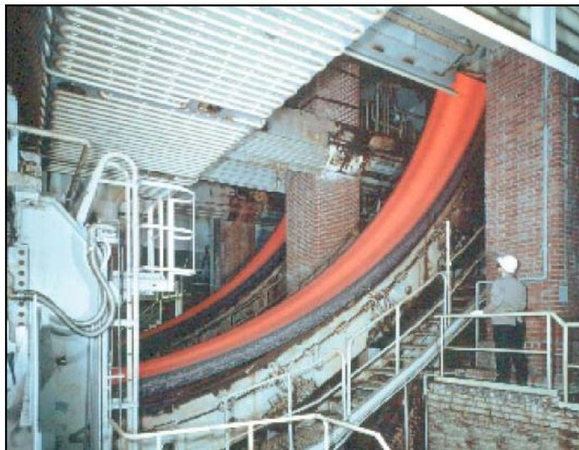
**Figura 65. Máquina de lingotamento contínuo em operação (Fonte: Iron and Steel Industry, 2012).**
