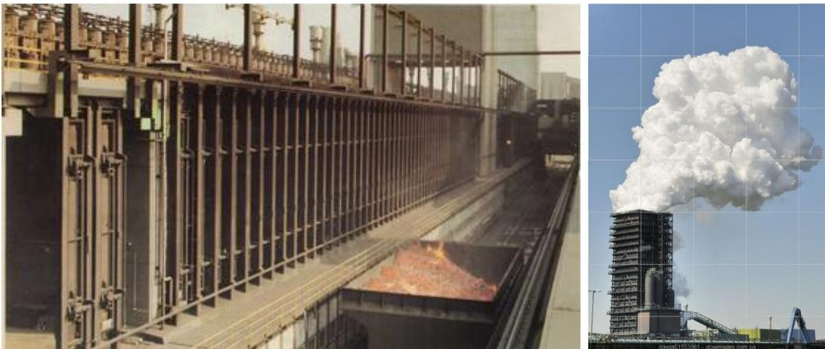
**Figura 49. Bateria de fornos de uma coqueria, com coque incandescente recém-descarregado (esq.) e torre de apagamento úmido de coque (dir.).**
