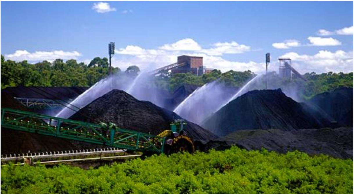
**Figura 42. Operação de aspersão de pilhas em pátios de matérias-primas (Fonte: ArcelorMittal, 2017).**
