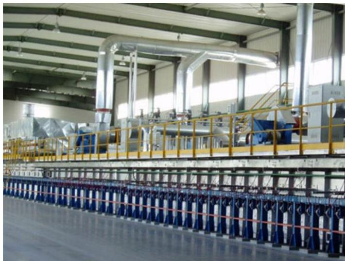
**Figura 18. Forno de recozimento.**
