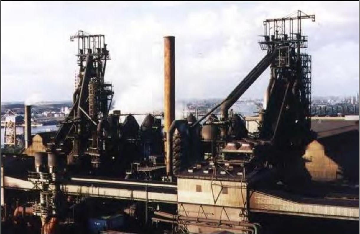
**Figura 55. Vista geral de dois altos fornos, com três regeneradores cada, com as respectivas chaminés para os gases de combustão provenientes dos regeneradores.**
