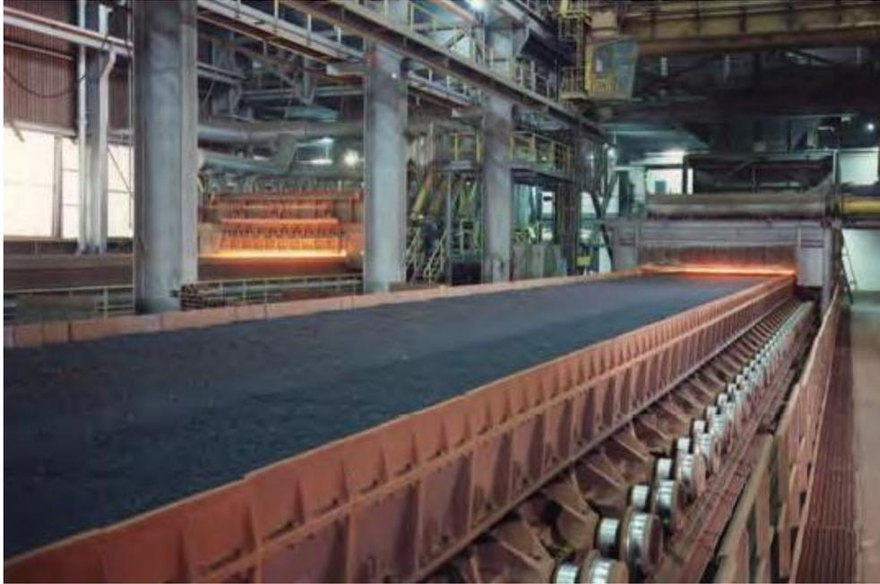
**Figura 52. Máquina de sinterização.**
