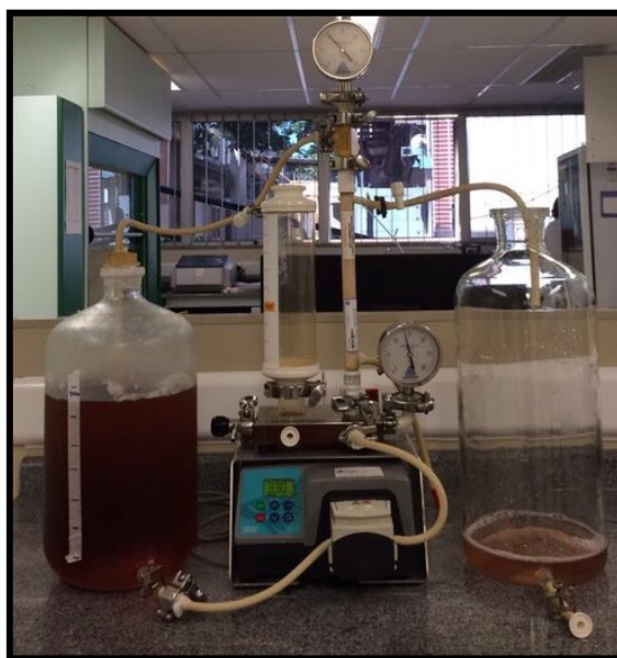
Figura 4.4. Sistema de filtração tangencial Hollow Fiber® utilizado para concentração do extrato bruto de celulases.
