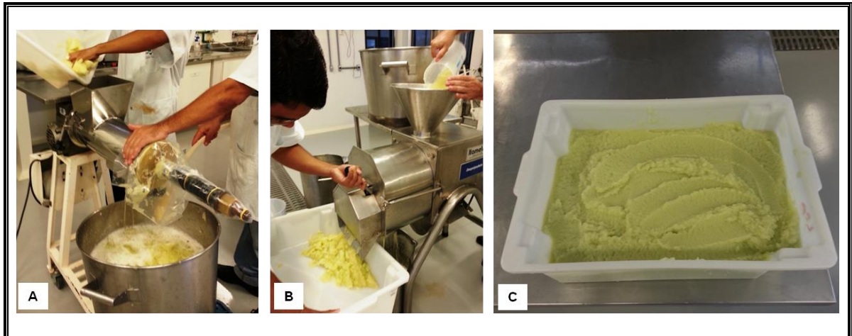
Foto 2. Operações e produtos obtidos no Processamento Integral da Polpa (PIP): Prensagem (A), Despolpamento (B) e o produto obtido do triturador que é misturado com a polpa (C).
