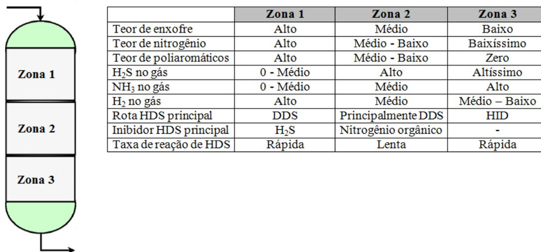
**Figura II.15.** Exemplo de um reator com três zonas (STANISLAUS *et al.*, 2010).
