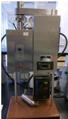
Figura 12: Foto de um sistema de filtração utilizado em testes de perda de circulação.
