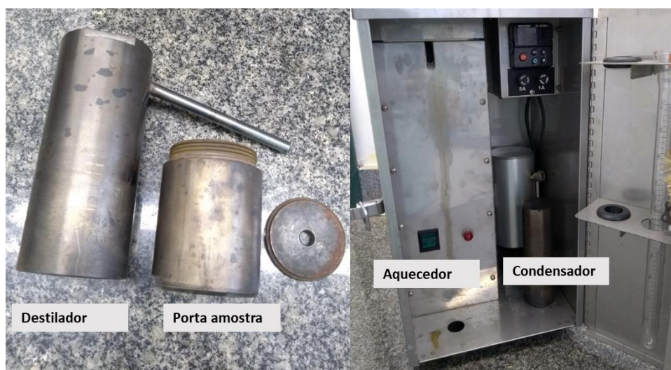
Figura 24: Porta amostra, sistema de destilação, aquecimento e condensação do Kit Retorta utilizados para separação dos sólidos da tinta magnética.
