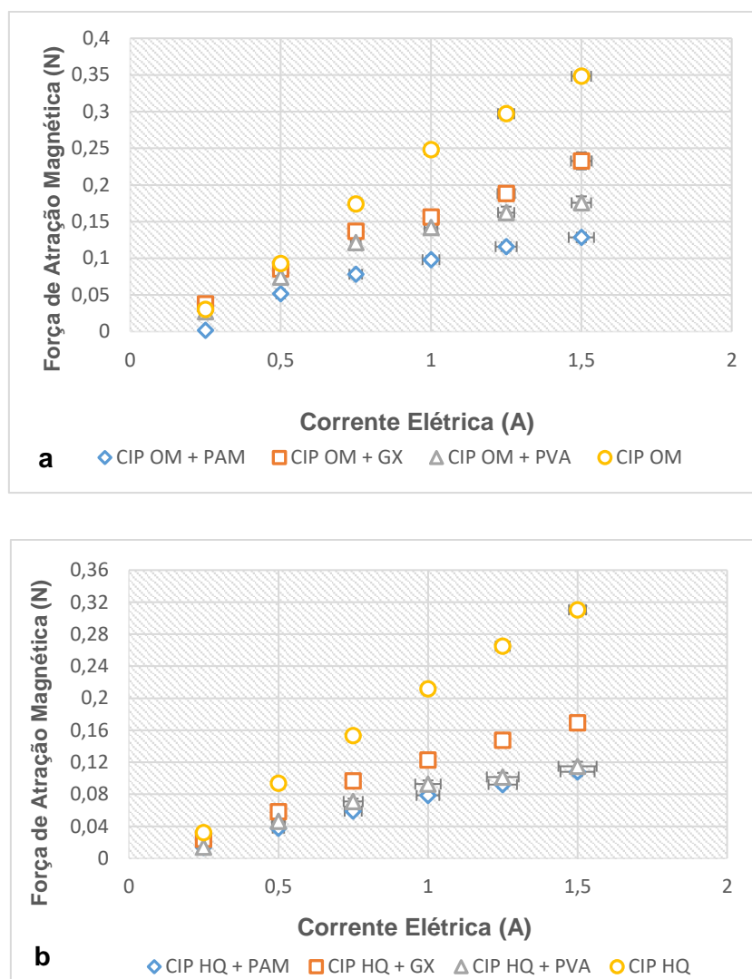
Figura 79: Avaliação da força de atração magnética das partículas CIP OM e CIP HQ puras e em diferentes meios de dispersão em função da variação do campo magnético. a) Resultados dos ensaios realizados com as partículas CIP HQ; b) Resultados dos ensaios realizados com as partículas CIP OM.
