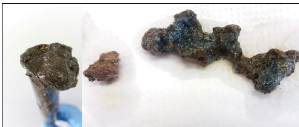
Figura 102: Reação descontrolada do FMR com o persulfato de potássio.
