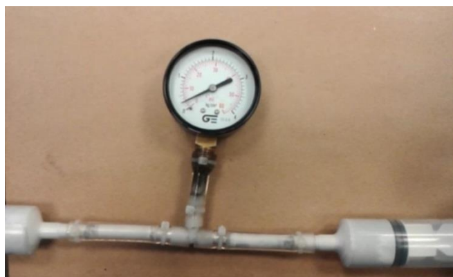
Figura 46: Adaptação do experimento com a inserção de um manômetro.
