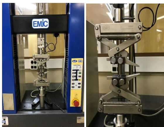
Figura 36: Equipamento utilizado nos testes de tensão (EMIC DL-2000).
