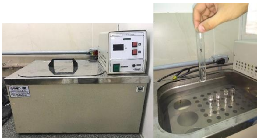
Figura 33: Banho termostático utilizado nos testes.
