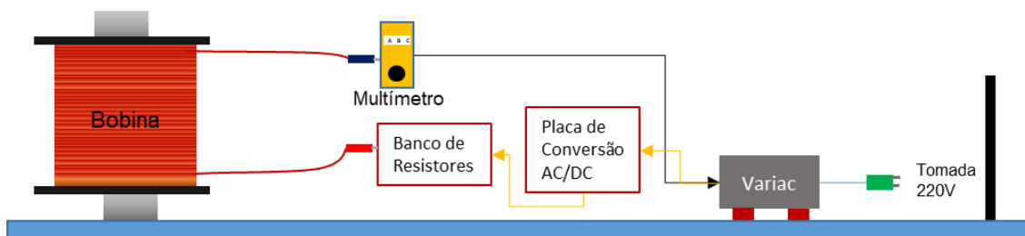
Figura 65: Esquema de controle de corrente que passa através da bobina responsável por gerar o campo magnético.
