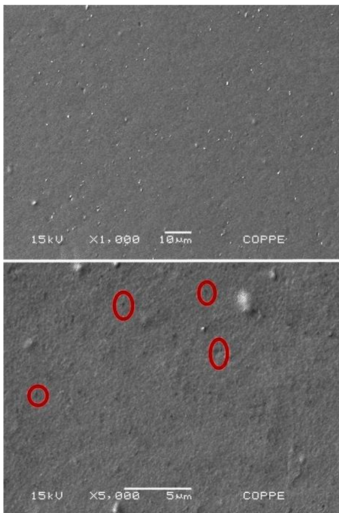
Figura 63: Fotomicrografias da superfície das amostras de filmes de PVC irradiados com FE nas doses de radiação de 50 kGy. (a)1000x; (b) 5000 x.
