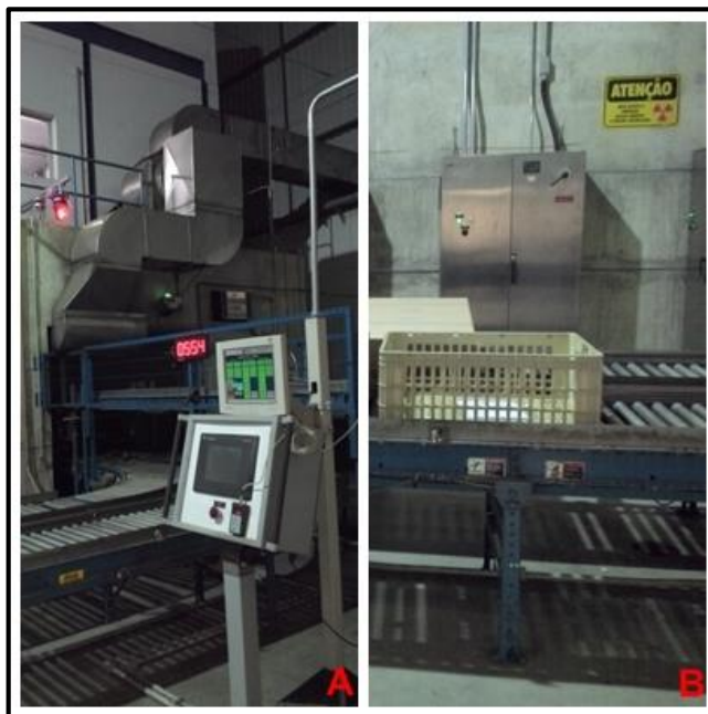
Figura 27: Irradiador industrial Linac modelo Titan. (a) Câmara de irradiação; (b) esteira de acondicionamento das amostras. Fonte: elaborada pelo autor (2016).
