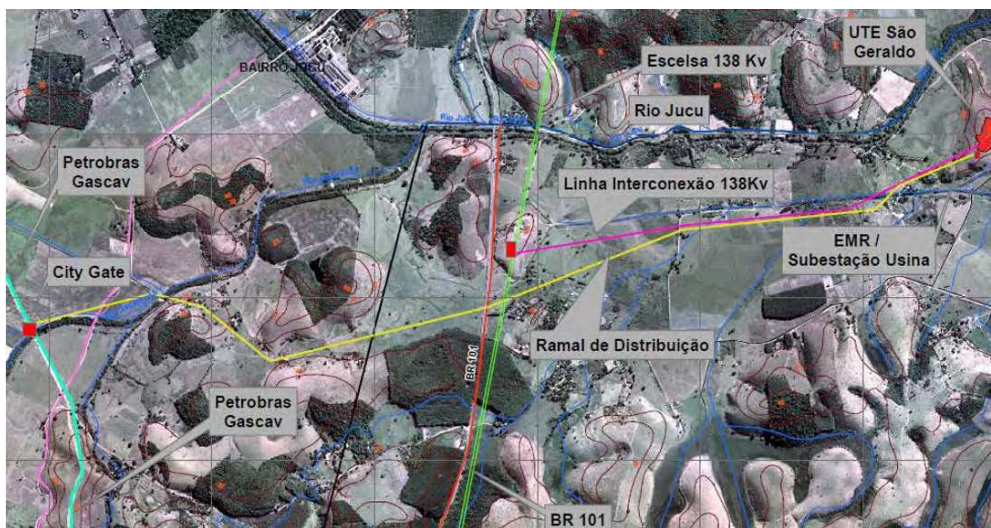
Figura 2 – Vista aérea do traçado da LT, do gasoduto e da localização da UTE São Geraldo I
