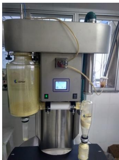
Figura 4. Spray Dryer em operação. (autoria própria)
