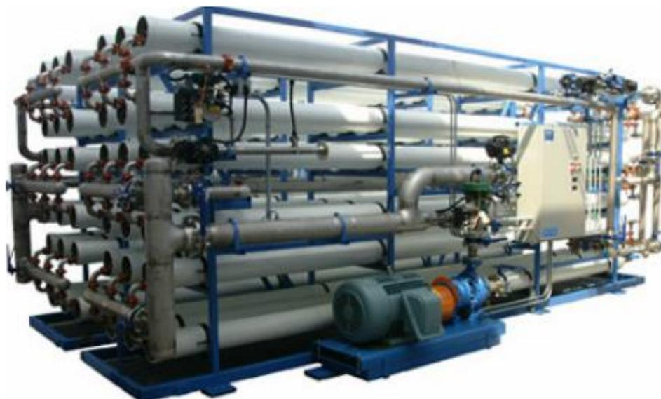
Figura 9: Ilustração de uma planta de osmose inversa. Fonte: GOMES, 2011.
