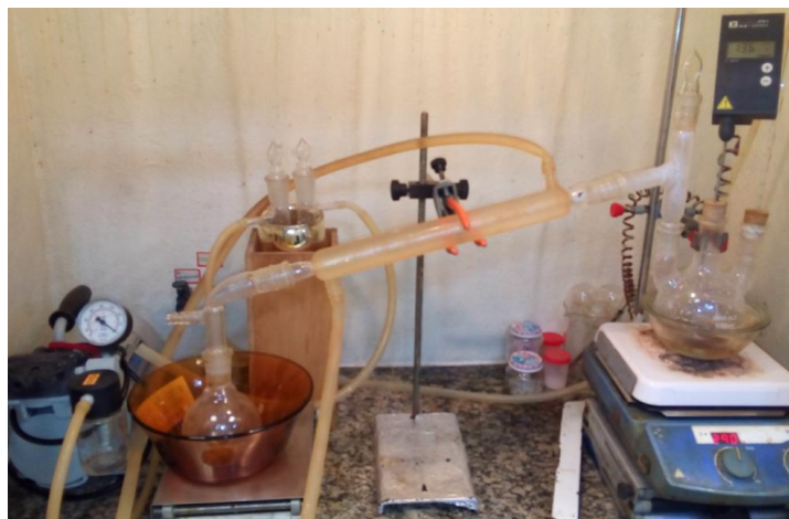
Figura 8: Esquematização do sistema proposto para a síntese do PBS.
