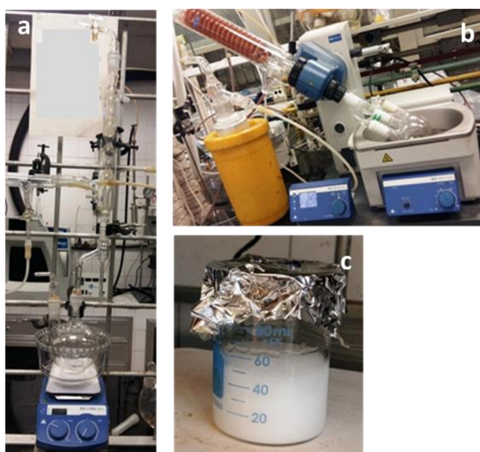
Figura 5. Funcionalização do P127 a) Sistema reacional, b) Rotaevaporação, c) precipitação do polímero
