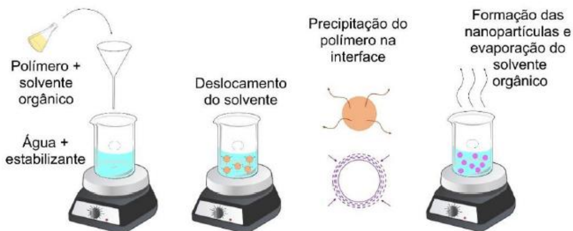
Figura 4 - Ilustração do método da nanoprecipitação
