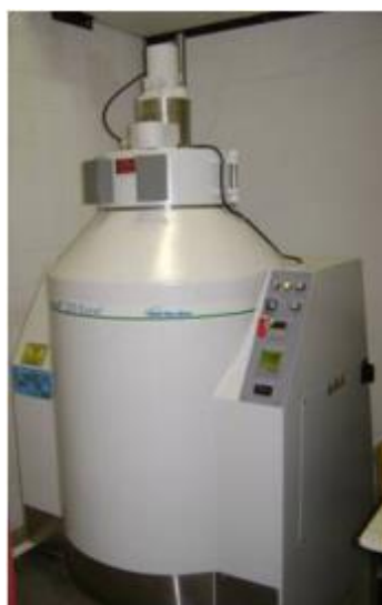
Figura 3: Irradiador Gama pertencente ao Laboratório de Instrumentação Nuclear da COPPE/UFRJ, ( Gammacell 220 Excel– MDS Nordion ).
