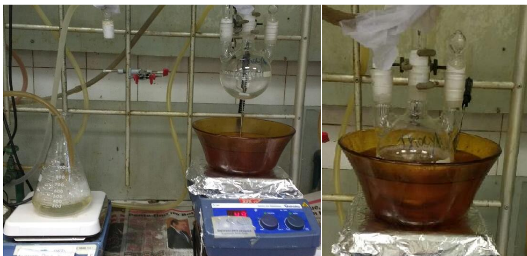
Figura 4.2.: Sistema reacional de obtenção dos copolímeros de PAM-g-BMA.
