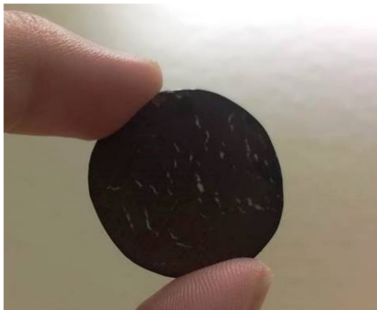
Figura 44. Visão macroscópica da aglomeração e separação de fases das nanocargas na matriz epóxi na amostra RE/NTC/NPG 1
