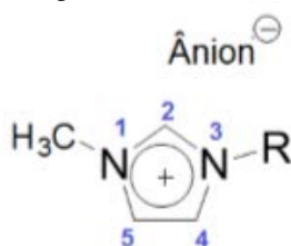
Figura 11. Estrutura genérica do LI a base de metil imidazol
