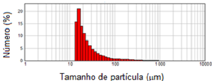
Figura 14 -Curva de distribuição de tamanho de partículas da NBR NP2021, obtidas pela análise por espalhamento de luz-MALLS.
