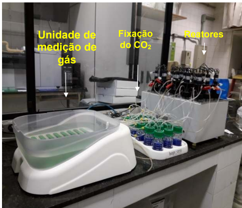
Figura 13 -Equipamento montado, contendo, da esquerda para a direita, unidade de medição do volume de gás, unidade de fixação do gás carbônico e unidade dos reatores em banho- maria.
