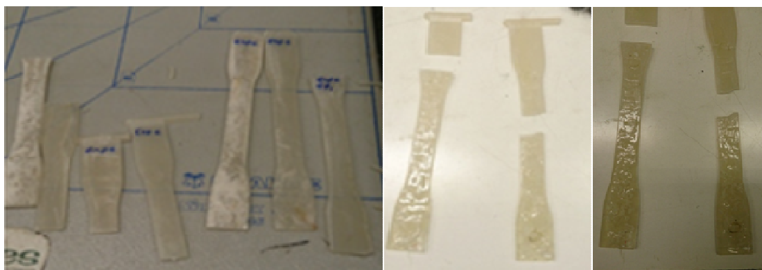
Figura 22 -Corpos de provas de tração das misturas PLA (Sc)/NP3083 (90/10, %, m/m).
