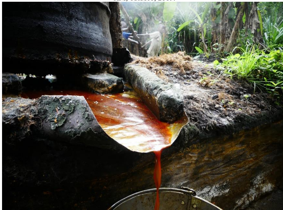
Figura 20: Óleo de palma de primeira qualidade descendo pela calha do cilindro. KM, outubro, 2019.
