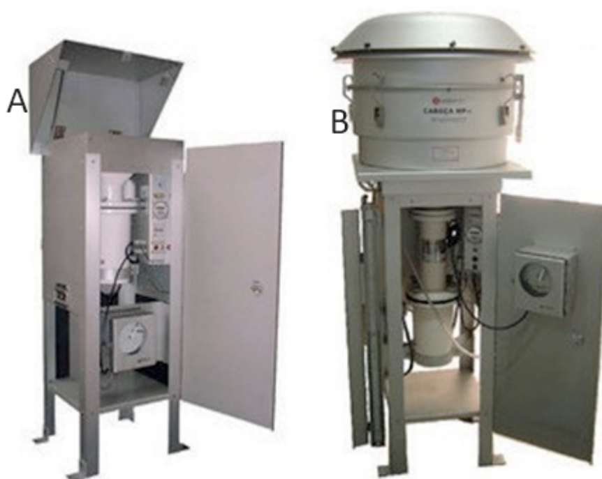
Figura 2 - Amostradores de Grande Volumes (AGVs) das estações Semiautomáticas de Monitoramento da Qualidade do Ar e Meteorologia do INEA. A) PTS, B) PM10 ou PM2,5.
